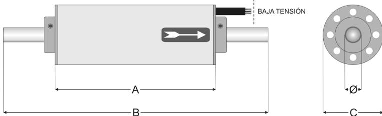
PLR modelo 018L - Debe ser instalado en espacios cerrados protegido contra las inclemencias del tiempo. El sistema hidráulico de la que se inserta debe tener una conexión a tierra conforme a lo dispuesto por la ley. En condiciones de ventilación insuficiente y bajo caudal de agua la superficie puede estar caliente.
