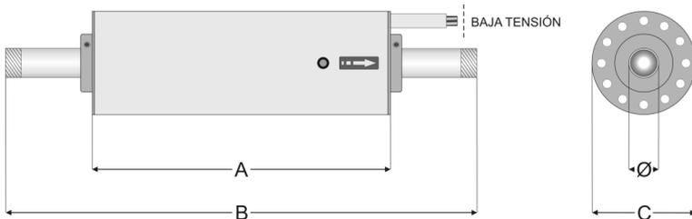
PLR modelo 021FI - Debe ser instalado en espacios cerrados protegido contra las inclemencias del tiempo. El sistema hidráulico de la que se inserta debe tener una conexión a tierra conforme a lo dispuesto por la ley. En condiciones de ventilación insuficiente y bajo caudal de agua la superficie puede estar caliente.
