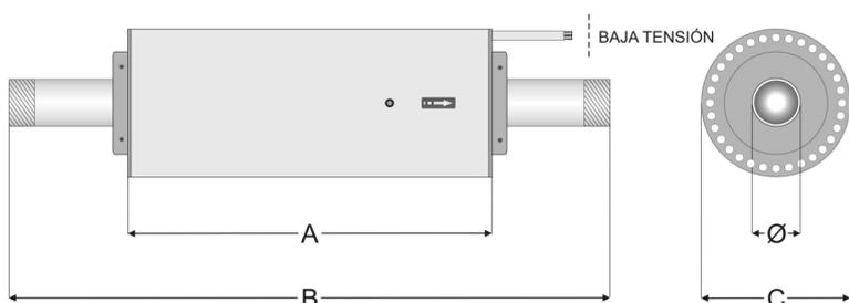
PLR modelo 049FI - Debe ser instalado en espacios cerrados protegido contra las inclemencias del tiempo. El sistema hidráulico de la que se inserta debe tener una conexión a tierra conforme a lo dispuesto por la ley.
