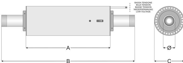
PLR modelo 060FI - Debe ser instalado en espacios cerrados protegido contra las inclemencias del tiempo. El sistema hidráulico de la que se inserta debe tener una conexión a tierra conforme a lo dispuesto por la ley. En condiciones de ventilación insuficiente y bajo caudal de agua la superficie puede estar caliente.
