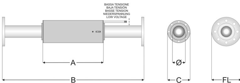
PLR modelo 076FL - Debe ser instalado en espacios cerrados protegido contra las inclemencias del tiempo. El sistema hidráulico de la que se inserta debe tener una conexión a tierra conforme a lo dispuesto por la ley.
