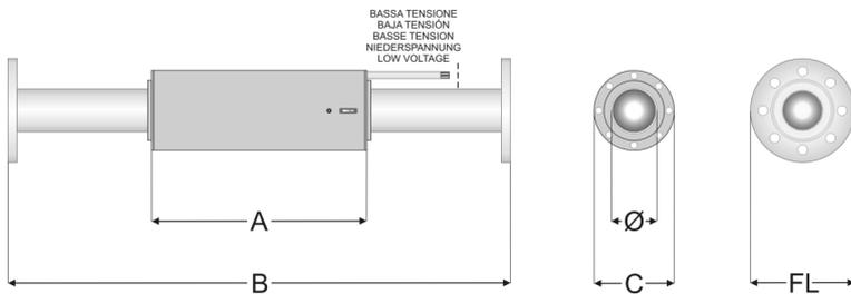
PLR modelo 90FL - Debe ser instalado en espacios cerrados protegido contra las inclemencias del tiempo. El sistema hidráulico de la que se inserta debe tener una conexión a tierra conforme a lo dispuesto por la ley.
