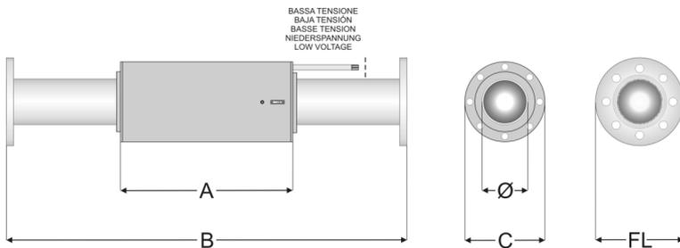
PLR modelo 114FL - Debe ser instalado en espacios cerrados protegido contra las inclemencias del tiempo. El sistema hidráulico de la que se inserta debe tener una conexión a tierra conforme a lo dispuesto por la ley.
