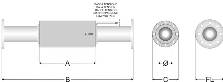
PLR modelo 200PVC - Debe ser instalado en espacios cerrados protegido contra las inclemencias del tiempo. El sistema hidráulico de la que se inserta debe tener una conexión a tierra conforme a lo dispuesto por la ley.
